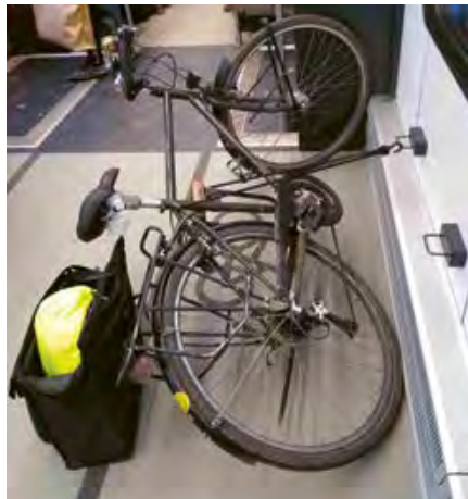
Bei seitlichen Sitzen sind die Befestigungspunkte unten zwischen den Sitzen, aber auch nicht überall. Ansonsten wie im Bild.
